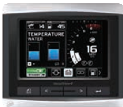
VesselView 4 pozwala monitorować 2 silniki w jednym czasie.
